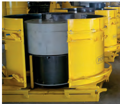
Монтажная высота изделий легко регулируется механизмом опалубки
