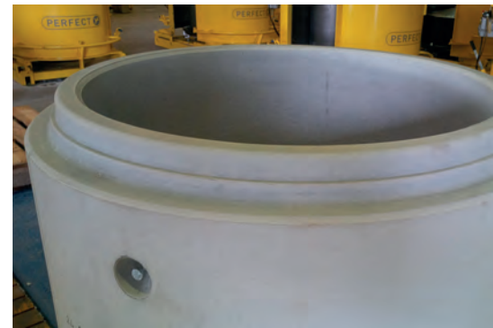
Замоноличенные в стенку колодца транспортировочные анкеры обеспечивают надежную погрузку и разгрузку колец с днищами на стройплощадке
